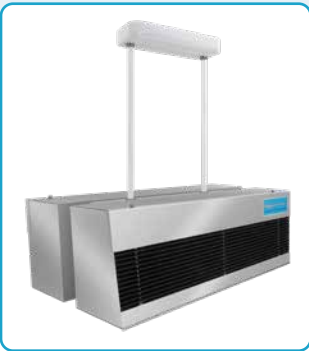
Figura 2 – Muestra la parte superior del Hygeaire® Modelo LIND24-EVO-2PM (arriba). Note los dos agujeros de montaje en la parte superior (para el juego de accesorios de montaje). El equipo debe ser instalado a una altura mínima de 7 pies (2.13 m) medida desde el fondo de la unidad hasta el piso. El punto de montaje debe poder cargar, de forma segura, un peso de 32 libras (14.5 kg).
